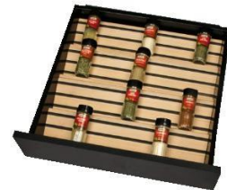
Woodline Gewürzeinsatz Element für LEGRABOX oder TANDEMBOX antaro Masse: T: 118 mm, H: 32 mm kann seitlich zugeschnitten werden Ausführung: Buche geölt oder Eiche geölt Für Zargenlänge 500 mm werden 4 Stück benötigt. (4 x T 118 mm = 472 mm, NL 500) Passgenau in K550 oder K600.
